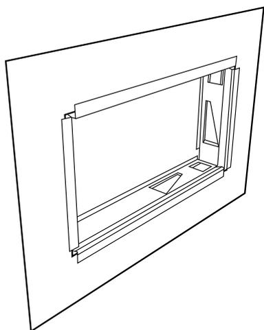
3 – Presionar el marco contra la pared hasta que quede como en la imagen, y fijarlo doblando las pestañas.
