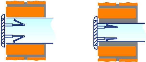
3. Las rejillas pueden adaptarse a diámetros comprendidos entre  $\varnothing_{Min}$  y  $\varnothing_{Max}$ .
