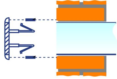
Empuje la rejilla hacia dentro del conducto. Los muelles de la parte posterior de la rejilla presionarán el interior del conducto quedando la rejilla fijada.
