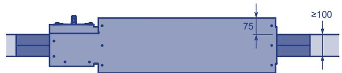
4. Colocar al compuerta en la correcta altura de modo que la junta esté centrada en la compuerta.
