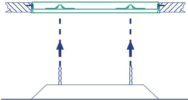
3. Placer le diffuseur E-DECOPLAC à l'intérieur du contre-cadre E-MMF. Le diffuseur peut se placer à 3 positions selon besoin: e = 35 mm, e = 45 mm et e = 55 mm
