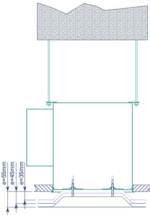
3. Placer le diffuseur E-DECOPLAC à l'intérieur du contre-cadre E-MMF. Le diffuseur peut se placer à 3 positions selon besoin:
