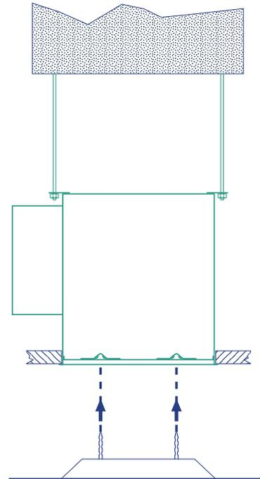
2. Placer le diffuseur E-DECOPLAC à l'intérieur de la BAB. Les clips du diffuseur feront un « click » quand le diffuseur sera fixé.
