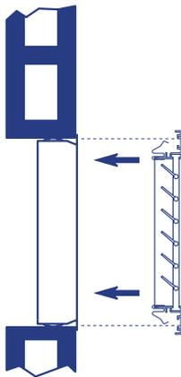
3. Placez la grille avec ressorts à l'intérieur du contre cadre. Appuyez d'abord sur un côté puis sur l'autre.
