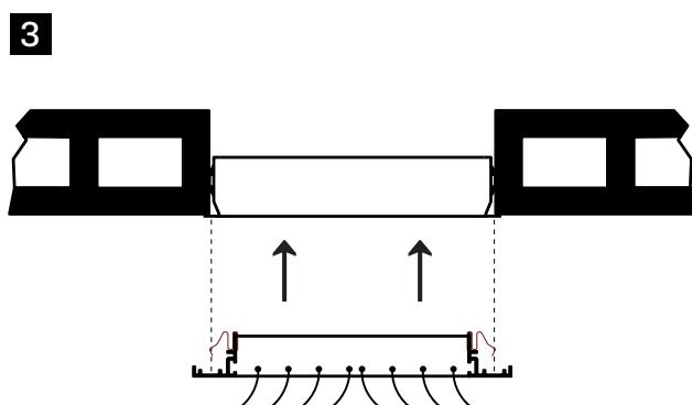
3. Installer la grille avec les ressorts à l'intérieur du cadre métallique. Appuyer d'abord sur un côté, puis sur l'autre.
