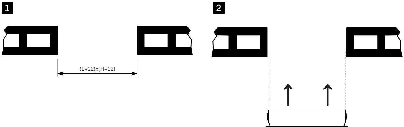
1. Ouvrir une ouverture dans le plafond aux dimensions  $(L+12) \times (H+12)$ .
